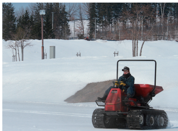
【写真：多目的広場の融雪剤散布作業のようす】
